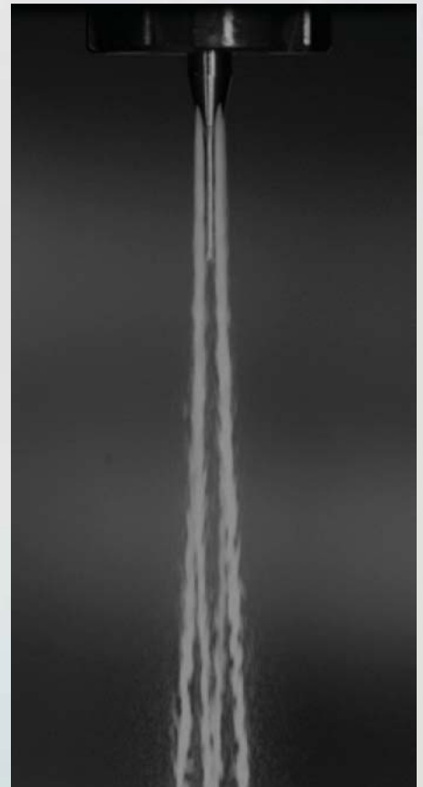
Innenkühlung mit 80 bar bei S=24.000 U/min
