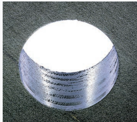
Bohrungsaustritt in unidirektionalem CFK Bohrung d = 6,35 mm
