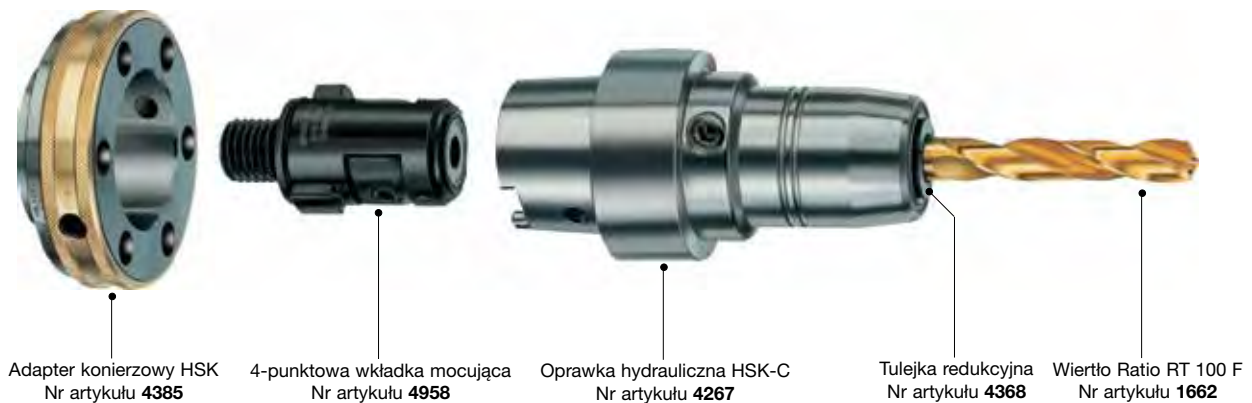
Przykładowa budowa połączenia HSK
